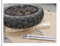
Schritt 1; Entfernen Sie das Rad und legen Sie es auf einen ebenen Untergrund. Achten Sie auf empfindliche Teile wie ABS-Ringe und Bremsscheiben. Lassen Sie keinen Schmutz in die Dichtungen und Lager eindringen.
