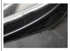
Schritt 8; Der Wulstabdrücker öffnet sich und drückt Reifen und Felge auseinander. Der Reifen muss über den Sicherheitsbuckel im Inneren der Felge geschoben werden. Wenn sich der Reifen beim ersten Mal nicht abschieben lässt, wiederholen Sie den Vorgang fünf Zentimeter nach links oder rechts.
