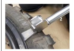
Schritt 5; Nehmen Sie Löffel 1 wieder heraus und achten Sie darauf, dass Löffel 2 an seiner Stelle bleibt. Setzen Sie nun den Drehpunkt auf Löffel 2, wie im obigen Bild gezeigt.
