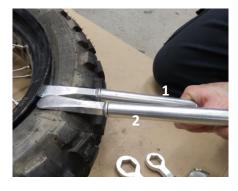
Schritt 3; Schieben Sie Löffel 1 so weit wie möglich nach unten und stecken Sie Löffel 2 neben Löffel 1, mit der Spitze nach unten.
