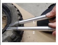
Schritt 4; Schieben Sie Löffel 2 so tief wie möglich, während Sie gleichzeitig den Druck nach unten auf Löffel 1 beibehalten. Die Spitze von Löffel 2 sollte hinter dem Reifenwulst hängen bleiben. Sie werden es spüren, wenn dies passiert.
