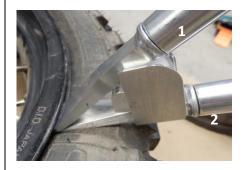
Schritt 6; Legen Sie Löffel 1 mit der Spitze nach oben in den Drehpunkt. Schieben Sie Löffel 1 vorsichtig zwischen Felge und Reifen. Stellen Sie sicher, dass Löffel 2 an seiner Stelle bleibt.
