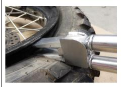
Schritt 7; Fassen Sie die beiden Hebel mit beiden Händen und drücken Sie sie zusammen, während Sie gleichzeitig Druck auf das Set ausüben und es in Richtung Felge drücken.
